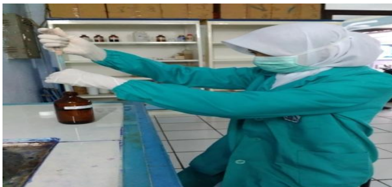
Memipet larutan NaCl 0,9% menggunakan pipet Westergren sebanyak 50 ml dengan bantuan karet penghisap
