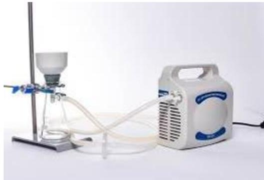
**Gambar 1.3 Filtrasi Corong Buchner**
