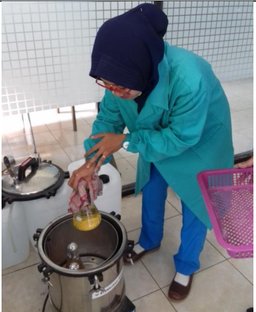
Sterilisasi media menggunakan autoclave
