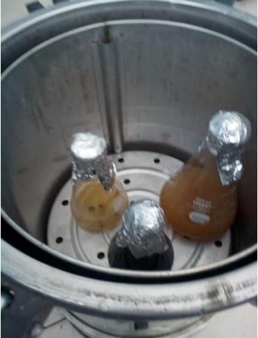
Sterilisasi media dengan autoclave
