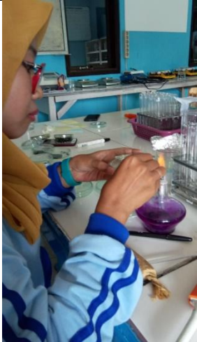
Meletakkan cakram yang direndam ekstrak pada media MHA
