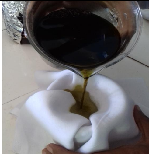
Penyaringan ekstrak yang sudah direndam etanol 96%
