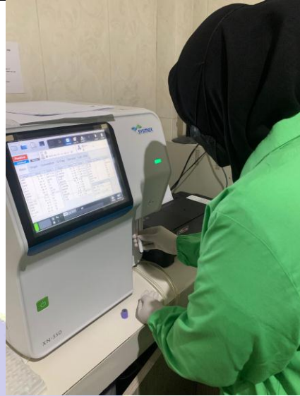
Membuka tutup pada tabung vakum dan meletakkan pada jarum penghisap sampai tanda hijau menyala
