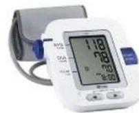
*Gambar 2.3 : Sphygmomanometer elektronik*
