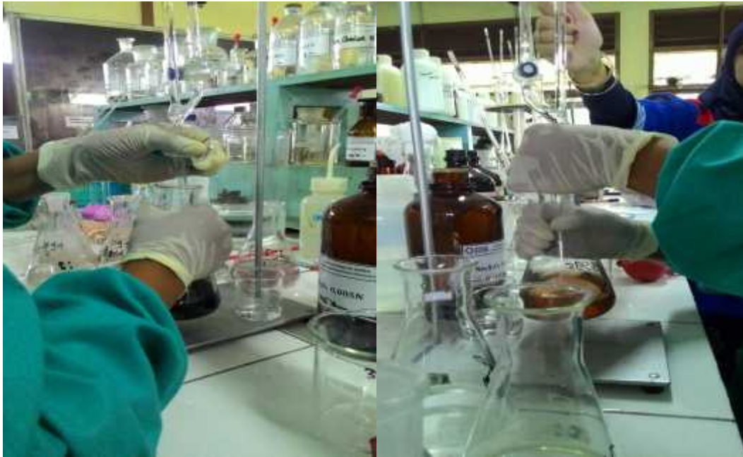
10. Dititrasi dengan \text{Na}_2\text{S}_2\text{O}_3 sampai warna biru hilang
