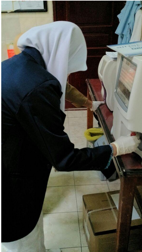
Proses Menganalisis Kadar Hemoglobin dengan hematology analyzer Mindray BC 3600
