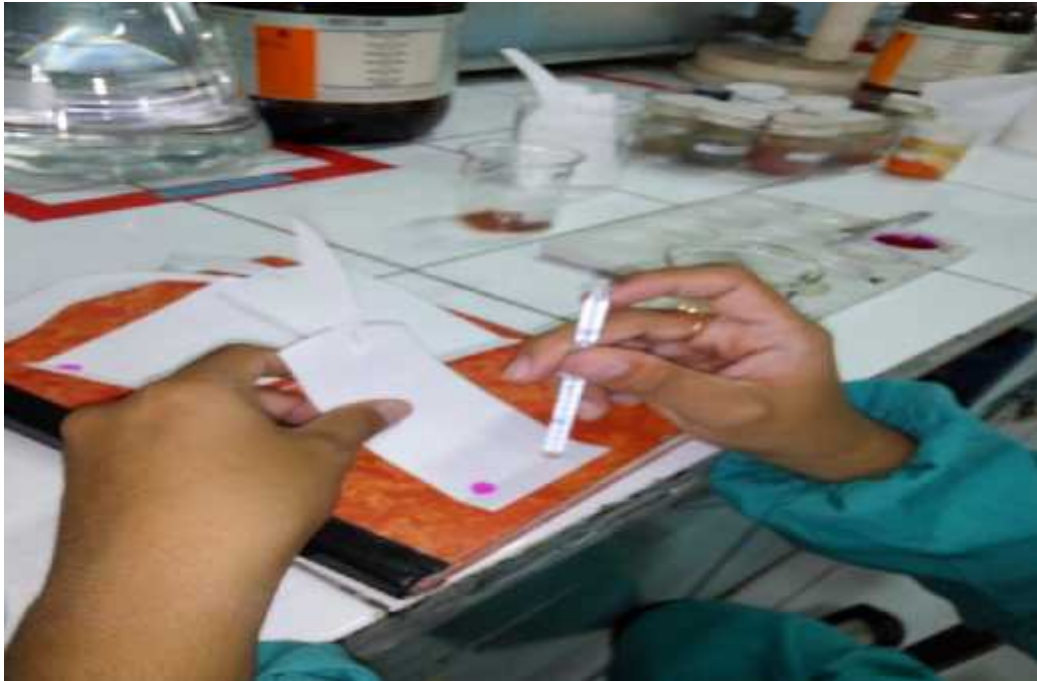
Menotolkan zat pewarna pembanding dan sampel pada kertas kromatografi
