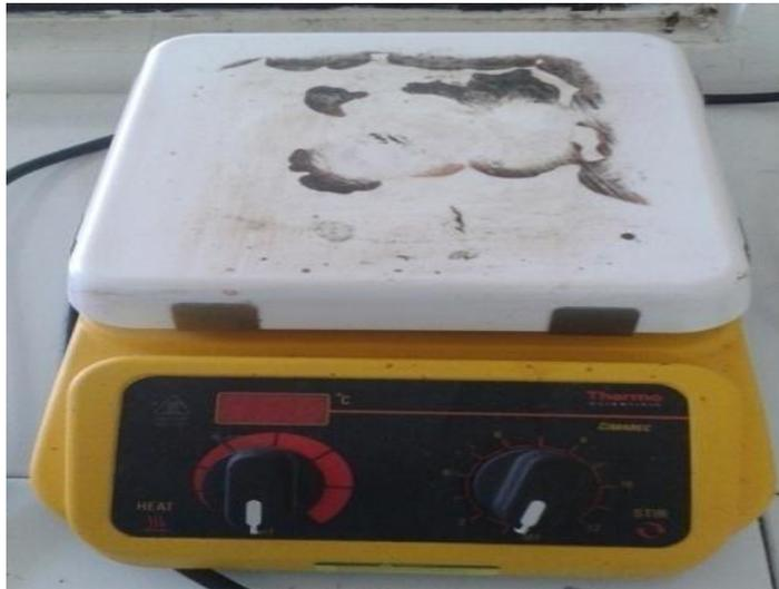
Gambar 10 Hot plate digunakan untuk memanaskan media SDA
