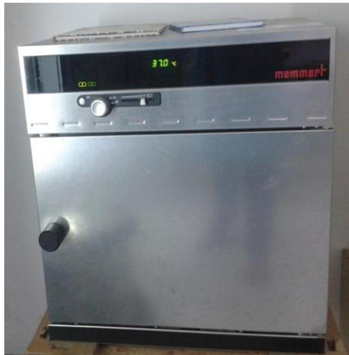
Gambar 13 *Incubator* digunakan untuk menginkubasi media untuk pertumbuhan jamur
