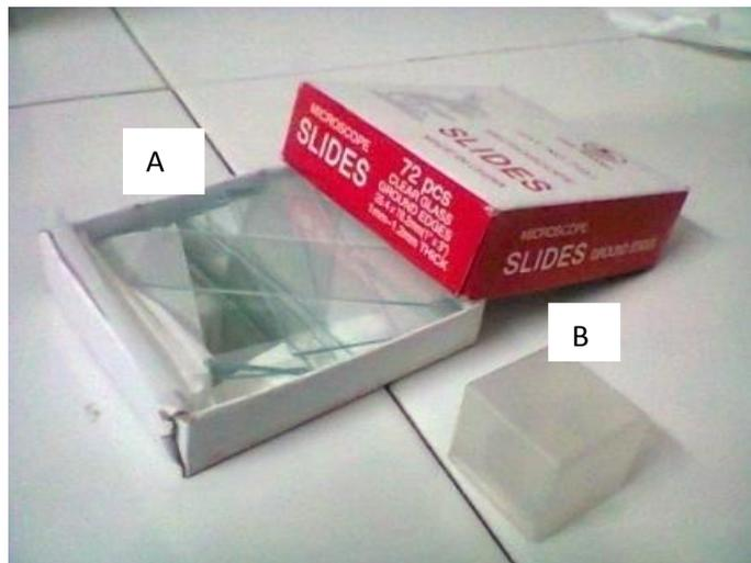
Gambar 2 A. Objek Glass digunakan sebagai tempat sampel kuku
