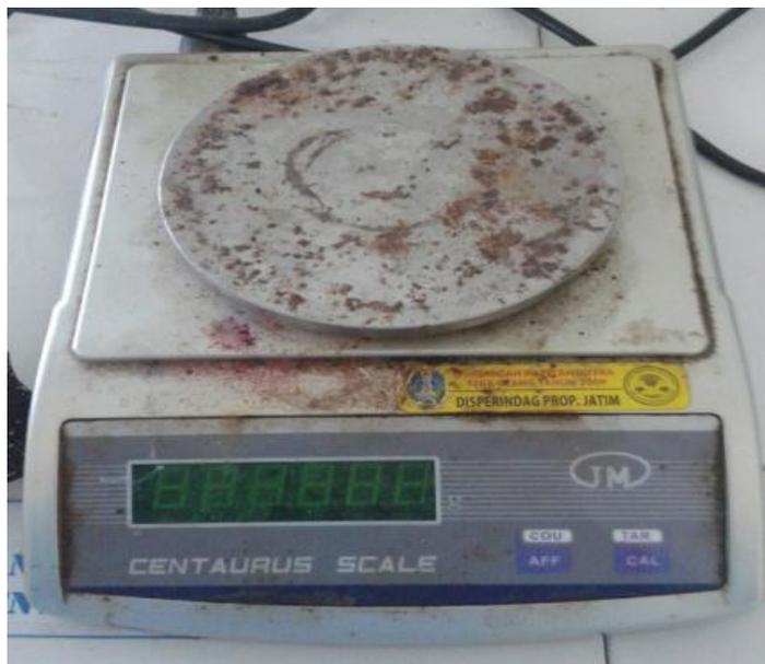
Gambar 11 Timbangan neraca analitik untuk menimbang media agar SDA
