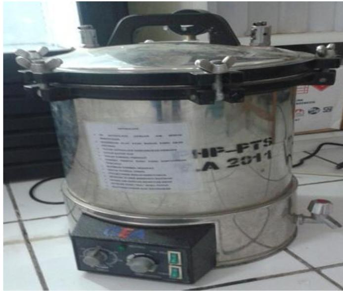
Gambar 12 *Autoclaf* digunakan untuk mensterilkan alat yang akan digunakan
