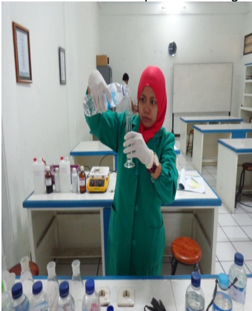
Gambar (10). Pengukuran sampel air sumur gali yang akan diujikan sebanyak 50 ml
