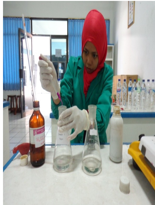
Gambar (13). Penambahan tetes demi tetes \text{KMnO}_4 0,01 N hingga warna pink
