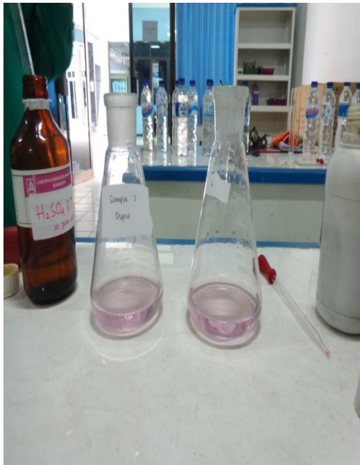
Gambar (14). Reaksi warna pink setelah penambahan \text{KMnO}_4 0,01 N
