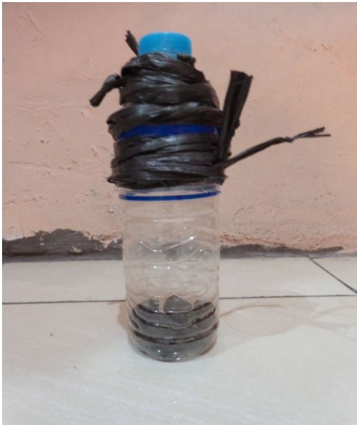
Gambar (7). Alat yang digunakan untuk pengambilan air sumur gali
