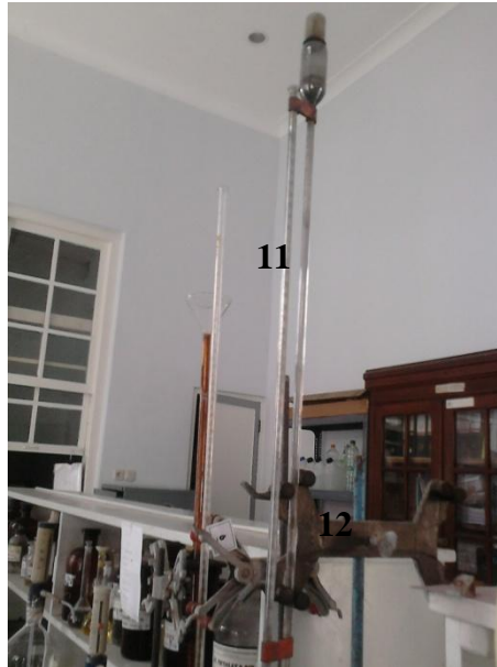
Gambar 11 : Buret digunakan untuk titrasi Gambar 12: Klem statif digunakan untuk menjepit buret dalam proses titrasi
