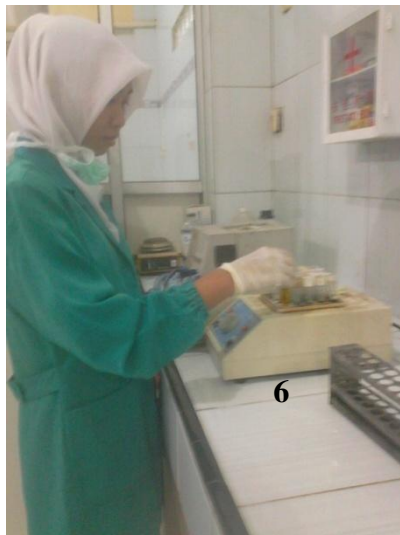
Gambar 6 : Peneliti memasukkan sampel uji COD pada alat COD reaktor
