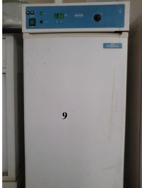
Gambar 9 : Inkubator yang digunakan untuk menginkubasi sampel BOD 5
