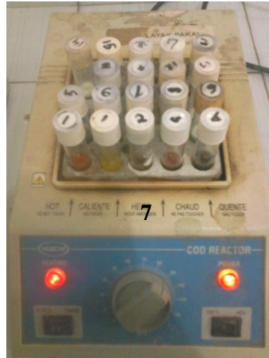
Gambar 7 : Sampel uji COD dipanaskan pada alat COD reaktor selama 2 jam pada suhu 150°C
