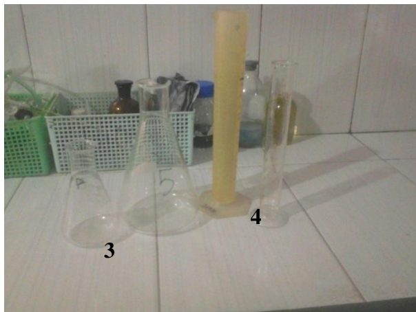
Gambar 3 : Erlenmeyer digunakan untuk menampung sampel yang akan di titrasi (BOD)
