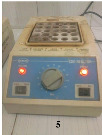
Gambar 5 : COD reaktor digunakan untuk pemanasan sampel COD
