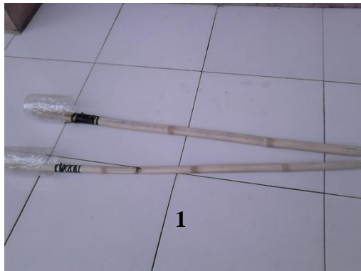
Gambar 1 : Gayung digunakan untuk mengambil sampel air sungai
