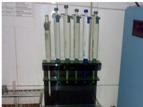
Gambar 3. Mikropipet 100 \mu l, 200 \mu l, 500 \mu l, dan 1000 \mu l dan yellow, blue tipe digunakan untuk memipet sampel serum.
