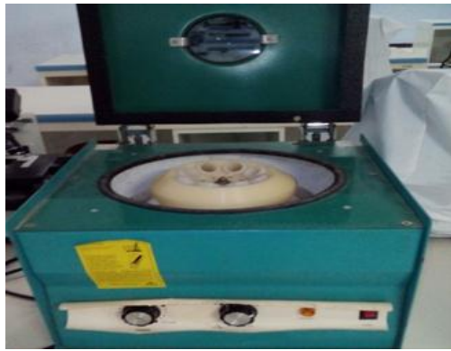
Gambar 1. Alat centrifuge digunakan mencentrifuge darah untuk mendapatkan serum.
