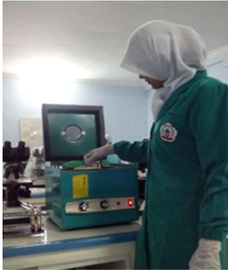
Gambar 1. Proses mencentrifuge sampel darah untuk mendapatkan sampel serum.
