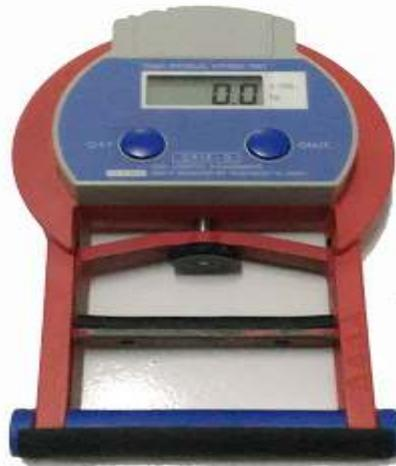
Gambar 2.2 Alat *Handgrip Dynamometer*
