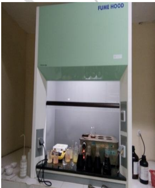
4.7 Proses penambahan larutan dan destruksi dilakukan di lemari asam
