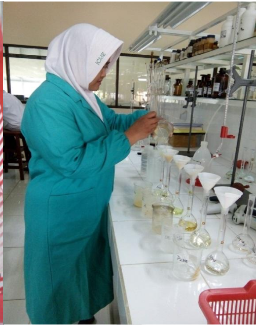
4.10 Proses penyaringan dengan kertas saring, lalu di addkan dengan aquades dan dihomogenkan
