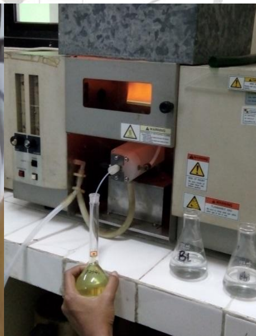
4.12 Pengukuran serapan sampel menggunakan SSA dengan panjang gelombang 283, nm.
