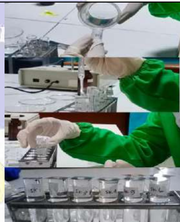
Pemindahan air rendaman kuku ke dalam tabung reaksi dan menutup dengan cover glass
