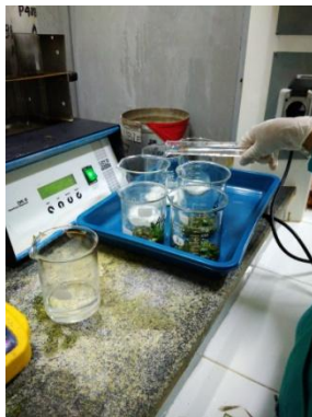
Memasukkan ke dalam sampel \text{HNO}_3
