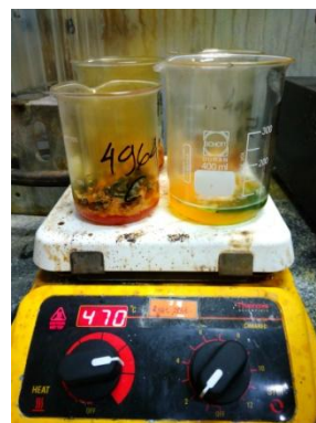
Memanaskan sampel dengan hotplate sampai suhu 400^\circ\text{C} untuk proses dekstruksi
