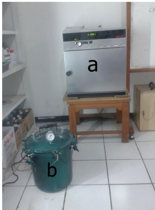
Gambar 4 Alat yang digunakan dalam penelitian yaitu terdiri dari incubator (a) dan autoclave (b).
