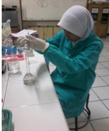
Keterangan : Memasukkan 2,26 gram serbuk NaCl ke beaker glass, menambahkan aquadest, mengaduk sampai homogen dan memasukkan ke labu ukur 250 ml
