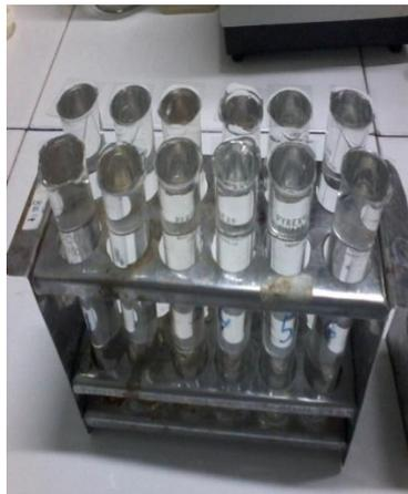
Keterangan : mengambil supernatant, menuangkan ke tabung reaksi sampai mulut tabung reaksi, menutup dengan cover glass, mendinginkan 30 menit, memindahkan cover glass dari mulut tabung reaksi diatas objek glass dan mengamati dibawah mikroskop perbesaran 10x lanjut perbesaran 40x
