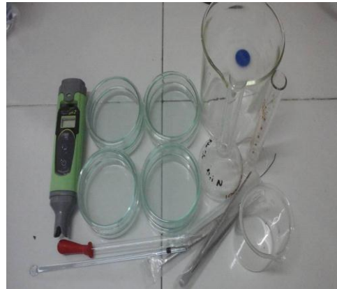
Peralatan praktikum identifikasi jamur: pH meter, beaker glass, cawan petri, pinset, pipet tetes, labu ukur, glass ukur
