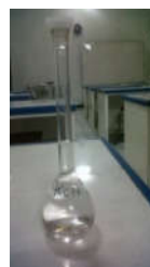
Gambar 4. Labu ukur digunakan untuk pengenceran reagen KOH 10%
