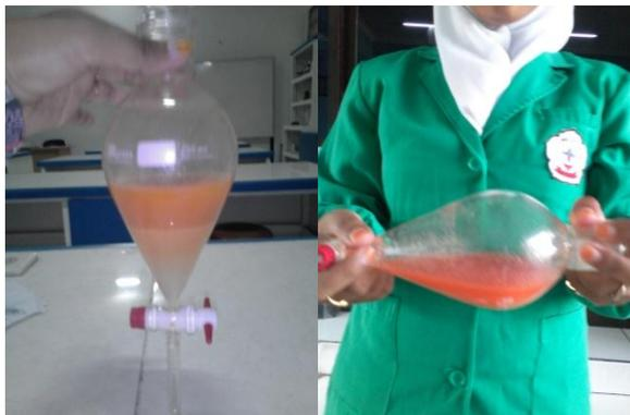
Gambar 4 memasukkan 100 ml sampel pada corong pisah kemudian menambah 5 ml HCl dan di ekstraksi dengan kloroform setelah itu mengocok
