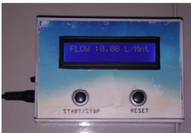
Fig. 4. Desain Modul Alat Kalibrator Gas Flowmeter
