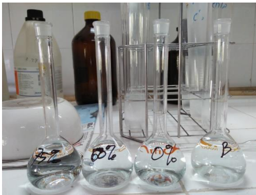
- Mengencerkan dan memasukkan hasil pemanasan pada labu ukur 100 ml.
