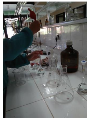
- Pengambilan 5ml larutan yang telah di encerkan kedalam enlenmeyer untuk di lakukan proses Destilasi.
