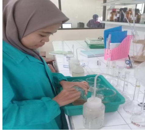
Melarutkan sampel dengan aquadest
