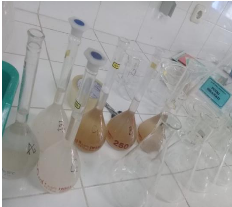
Memindahkan sampel kedalam labu ukur
