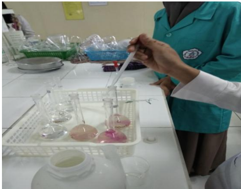
Menetralkan larutan dengan NaOH
