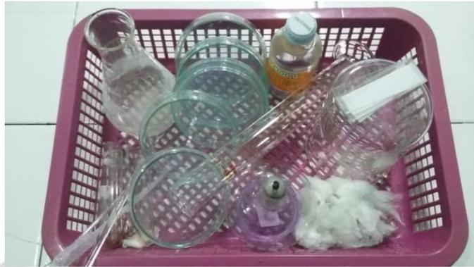
Gambar 1.1 Pada wadah tersebut terdapat cawan petri, botol, kapas, Erlenmeyer, beakerglass, cover glass, obyek glass, lampu spirtus, pipet tetes, tali, botol kaca, tabung centrifuge, gelas ukur, dan batang pengaduk.
