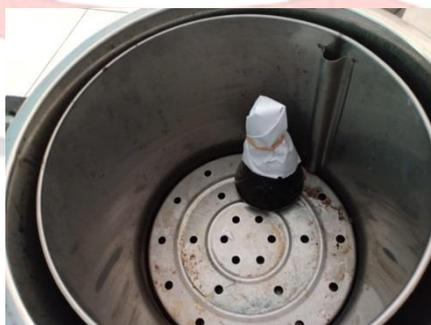
Gambar 3.5 Media SDA dimasukkan kedalam erlenmeyer dan di sterilisasi dengan autoclave selama 15 menit dengan suhu  $121^{\circ}\text{C}$
