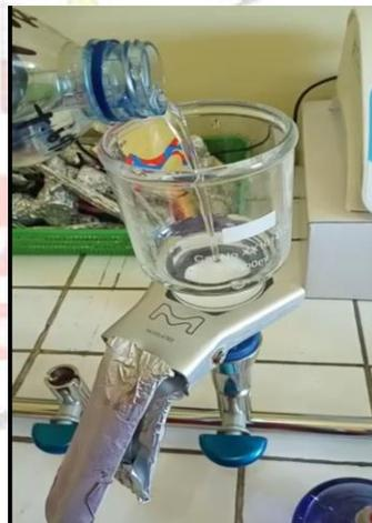
4. Menuang sampel untuk dilakukan penyaringan
