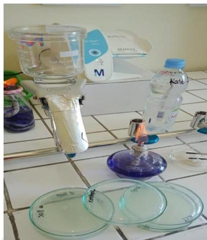
6. Memindahkan membrane filter ke media untuk diinkubasi
