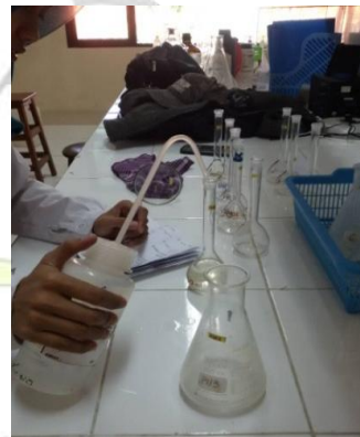
9. Memindah ke dalam Labu ukur Kemudian diadddkan dengan aquadest sampai tanda batas dan di saring .
