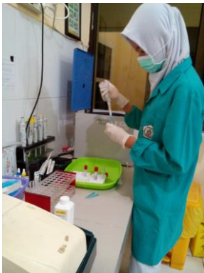
Meletakkan Serum Ke dalam kuvet sampel
